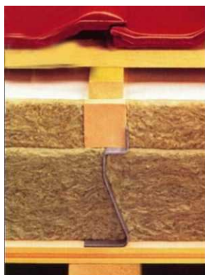
Obr.č.28: Nadkroevní zateplení kov.držák rockwool
