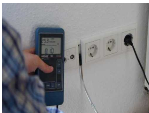
Obr.č.22: Profoukávání stud.vzduchu elektroinstalací
